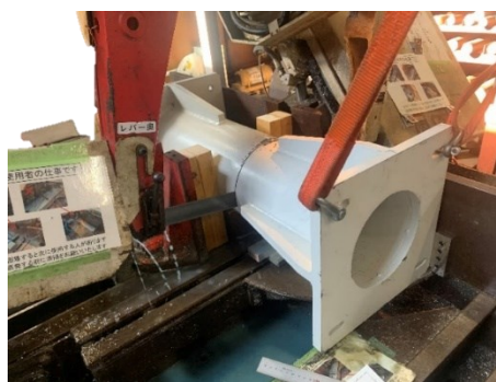
図2. のこ盤で長さを詰める加工
