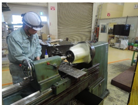
図3. 旋盤で端面仕上げと開先加工
