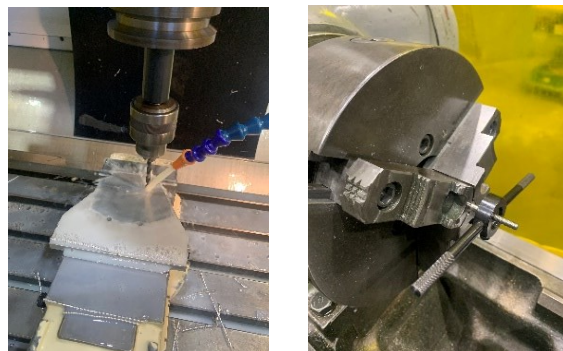
図7. フライス盤と旋盤で加工中の様子
