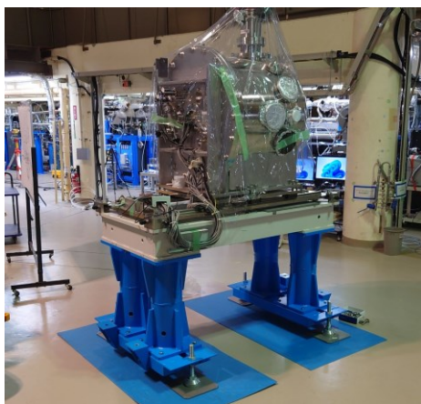
図1. 完成した架台の脚とベース (青色)
