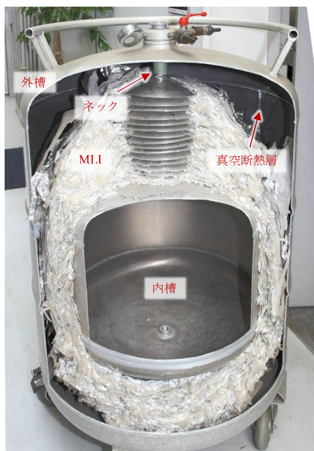
図6. 液体ヘリウム容器カットモデル[11]
