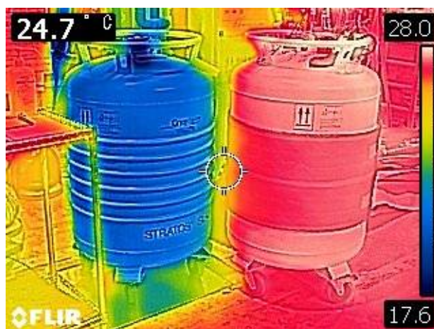
図 5. 外槽温度 左：液体窒素予冷中の容器 18°C 右：液体ヘリウムで運用中の同型容器 28°C
