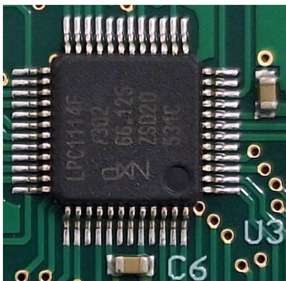
図4：マイコンにおける電源デカップリングコンデンサの配置状況
