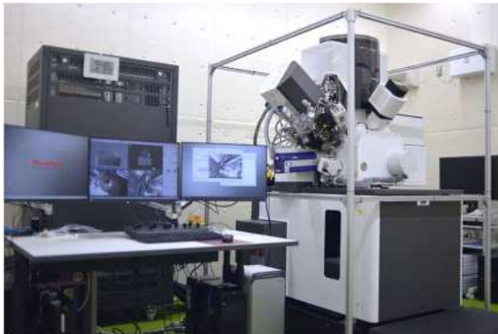
レーザー／プラズマ集束イオンビーム 加工観察装置（Laser PFIB） Helios 5 Laser Hydra
