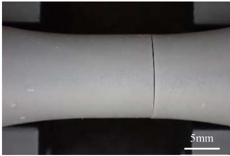
図 4. 引張・圧縮負荷 ( \Phi = -0.5 )
