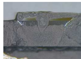
図2 筆による塗布例 (水溶性カーボンペースト)
