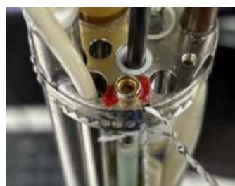
図 1. マジックアングル調整機構の固着箇所
