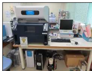
図 3 X 線分析顕微鏡 XGT-7200V（堀場製作所） （以下、「XGT」）
