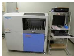
図 2 波長分散型 XRF ZSX-PrimusII（リガク） （以下、「WDX」）
