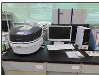
図 1 エネルギー分散型 XRF EDX-8000（島津製作所） （以下、「EDX」）
