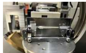
図 2. ステージに固定したキャピラリー
