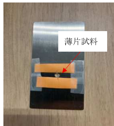
図 2 薄片試料と固定治具
