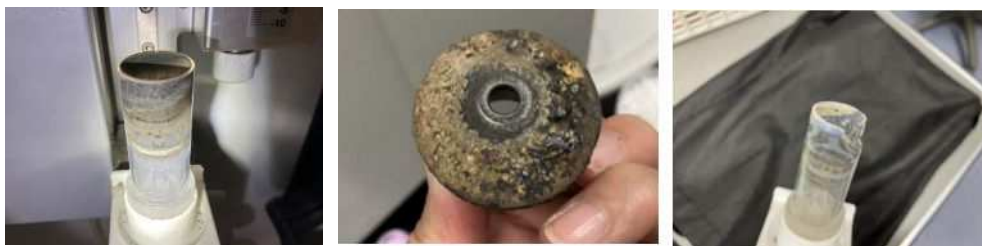
図1 左) 汚染の酷いトーチ先端 中) 錆の発生したコーン 右) 溶融したトーチ先端
