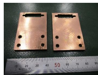
図4. cold_plate4dsub (純銅 C1020)
