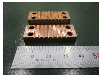
図3. thermal_anchor_plate_086 (純銅 C1020)
