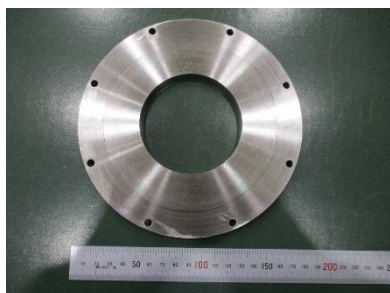
図1. chamber_bottom (ステンレス鋼 SUS304)
