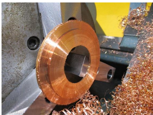
図9. flange_50K 旋盤加工
