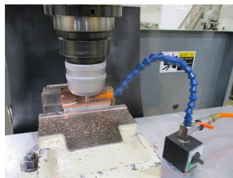
図12. cold_plate_42 フライス盤加工の様子
