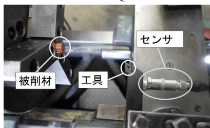
図 1. 旋削工具振動センシングの装置構成
