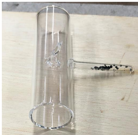
図 12. ヨウ素封入が終了したテスト用セル
