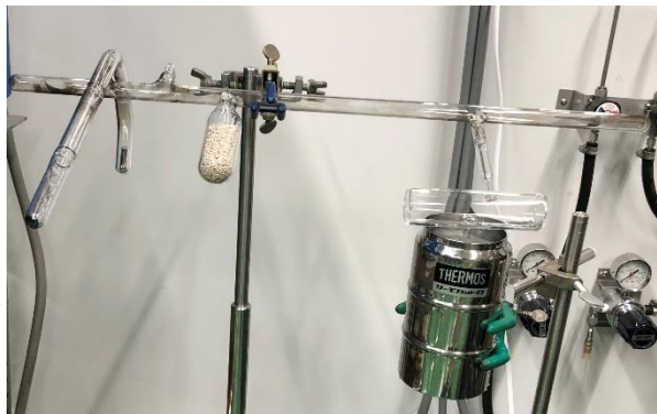
図 11. 石英セルへヨウ素封入の様子
