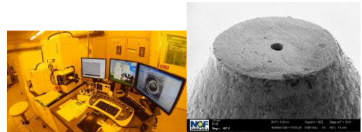
図 14. FIB 装置と加工した先端微細孔
