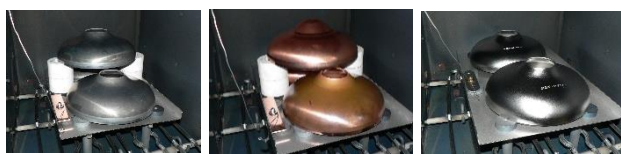
a) アルミ b) 銅 c) ニオブ 図2 各素材のハーフセルアニール
