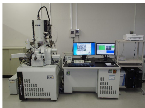
図3. 研修で使用したSEM/EDS(学内備品)
