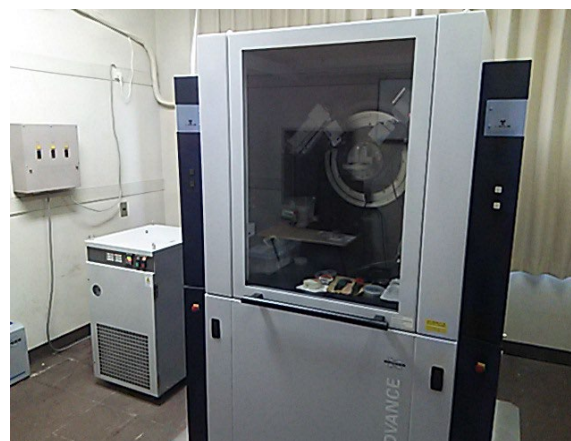
図4. 研修で使用したXRD(学内備品)
