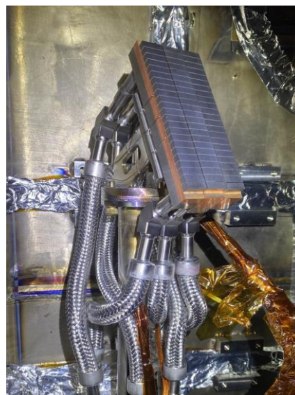
図5 LHD にインストールされたダイバータテストモジュール
