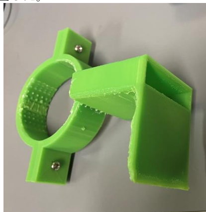
図4. 3Dプリンターで製作したカメラ固定治具
