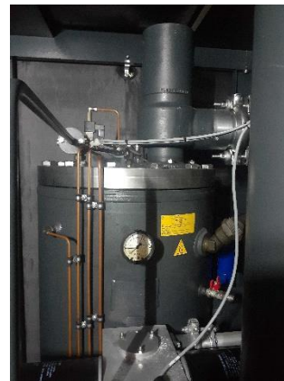
図 1. オイルタンク 上部にオイルセパレーターが入っている
