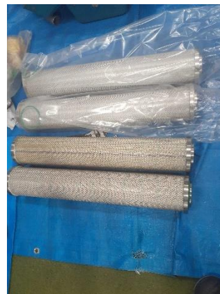
図 7. コアレスフィルター 上が新品で下が使用後 少し汚れている
