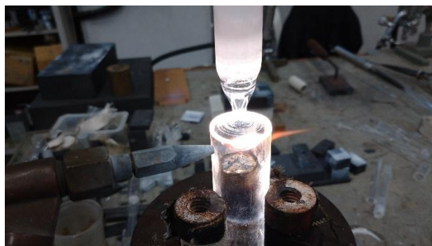
図5 容器と蓋を溶接中
