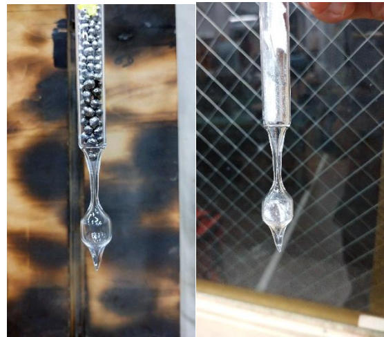
図 13 加工例④ 右：熱処理前、左：熱処理後
