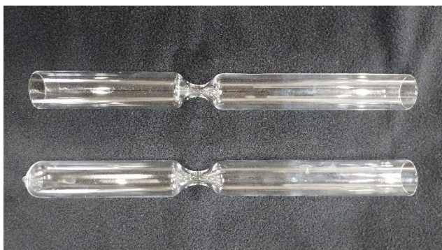
図3 括れをいれたガラス管と片方封じ前と封じ後
