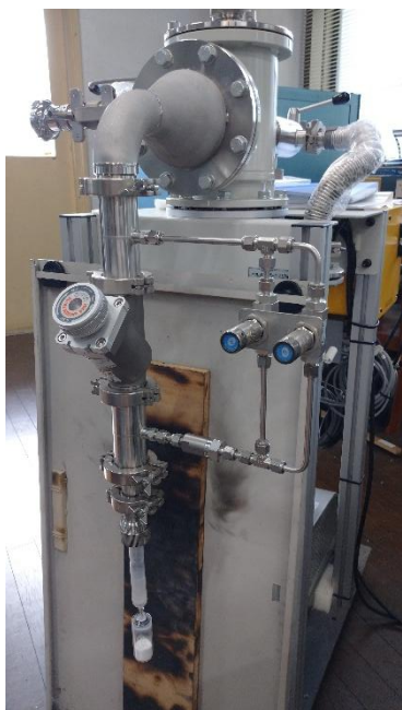
図7 ナノ粒子試料を真空封入中
