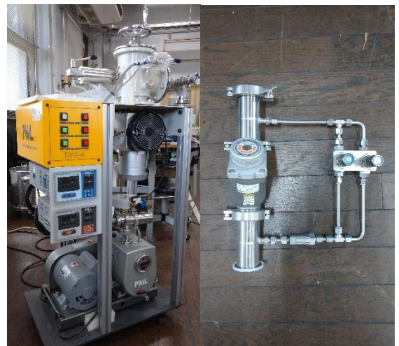
図2 左：高真空排気装置、右：ニードル弁
