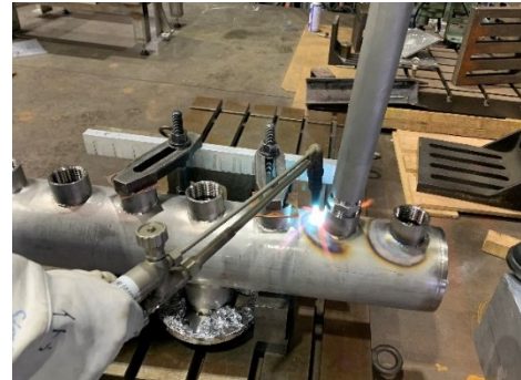
図7. ガストーチで曲げ修正
