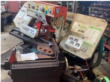
図 1. バンドソーでパイプを 45° に切り出し
