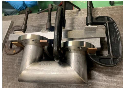
図 2. フランジと配管の位置調整
