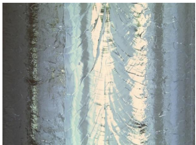
図6 空洞内面ビード部
