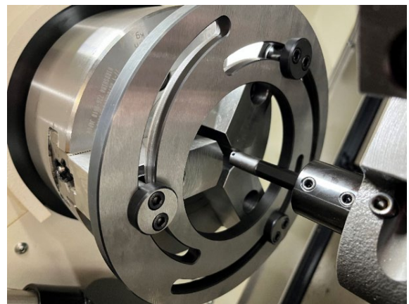
図 3 チャックメイトを用いた加工準備時の様子
