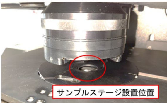
図 2 プラスチックごみ分析用 FT-IR 装置
