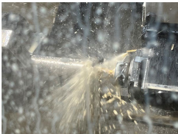
図4 Φ20mmのドリルを用いた加工の様子
