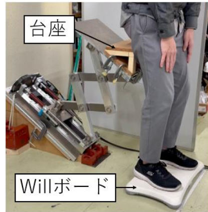
図 7 床反力測定を用いた動作実験
