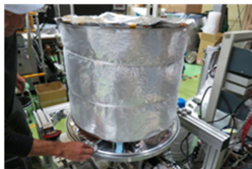
図 5 内槽に SI-30 層を巻いた様子
