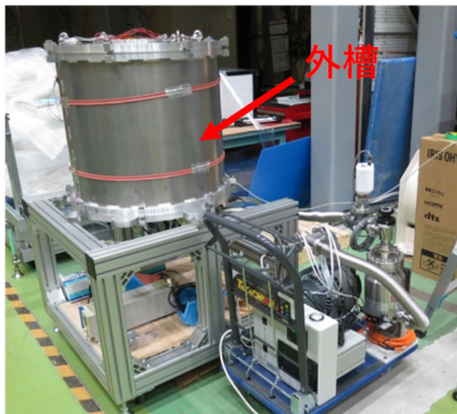
図1 クライオスタットと排気装置
