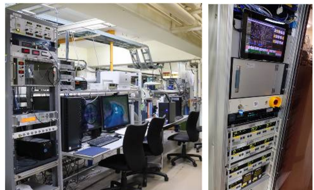
図 2 ビームライン制御(左)、インターロックシステム(右)
