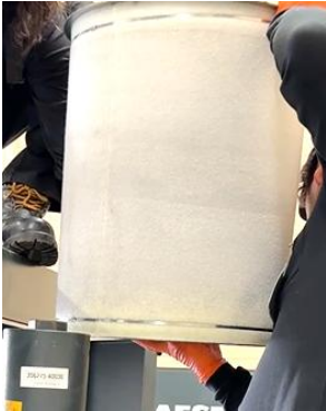
図5 オイルセパレーター 少し変色あるが綺麗
