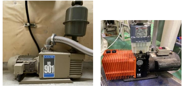
図8 ロータリーポンプ 左: 90 m 3 /h、右: 15 m 3 /h
