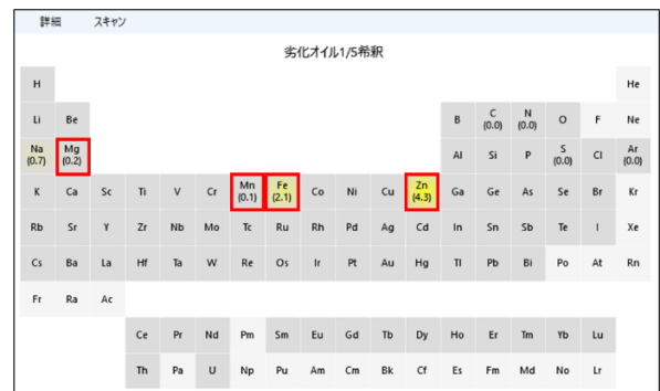
図11 劣化オイル測定結果画面 赤枠が劣化オイルのみで検出された元素 黄色がより濃い元素の検出量が多い
