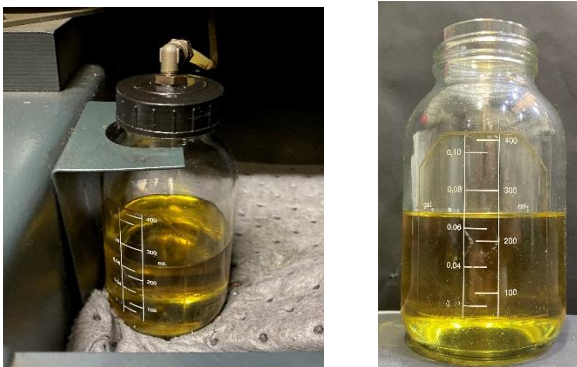
図 1 8 オイル漏洩量 250mL/運転時間 670h
