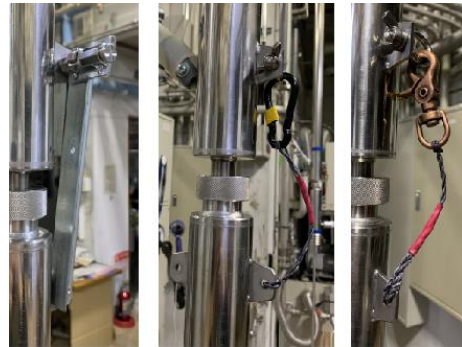
図4 延長管脱落防止具の検討
