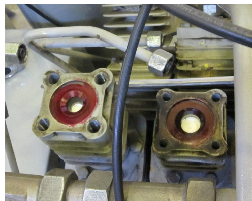
図11 シリンダーの浸透探傷試験
