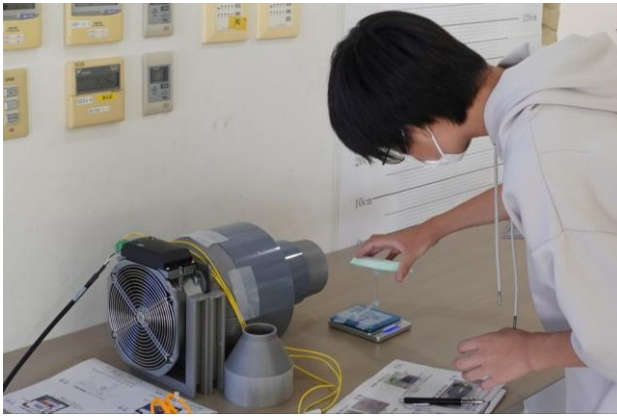
図 10 小型風洞で揚力を計測
