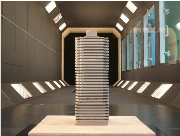
図2 模型を設置した風洞測定部内の様子
