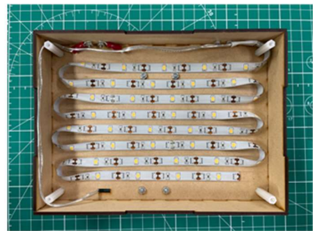
図 2 組み立て途中のライトフレーム
