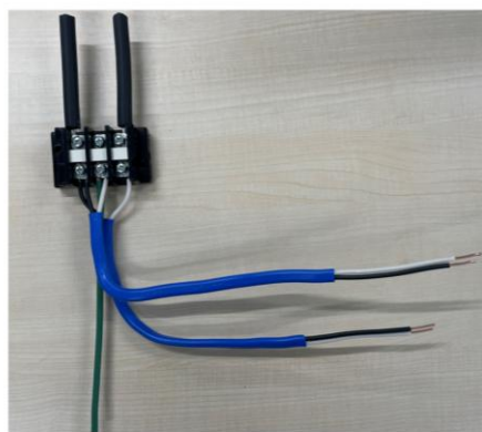
図6 高圧側の結線例資料
