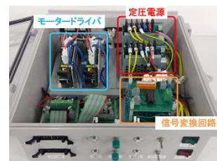
図4 実習用リーダー・フォロワ式遠隔操縦ロボット (上：ロボット本体 下：制御盤)
