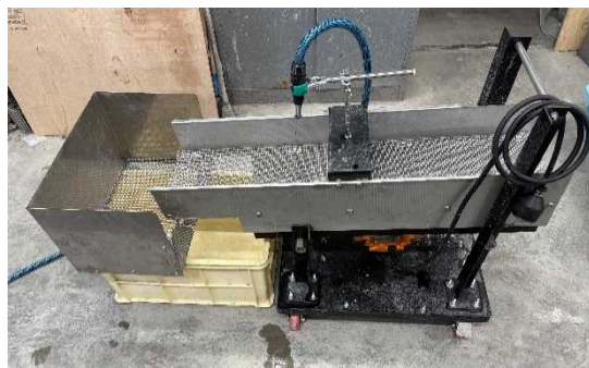
写真5 粗骨材回収装置
