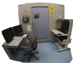
(b) マイクロフォーカス X 線 CT スキャナ TOSCANER 32300
