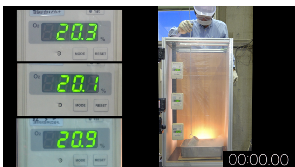
図3 液体窒素が漏出した際の密閉空間内の酸素濃度変化の動画教材
