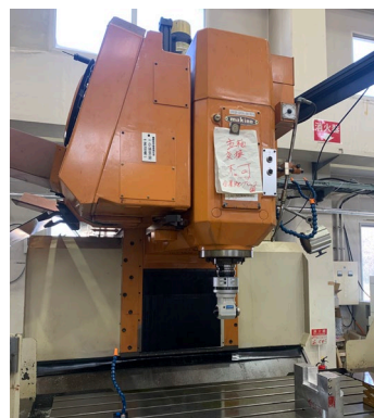
図4 FNC128 (アングルヘッド装着時)
