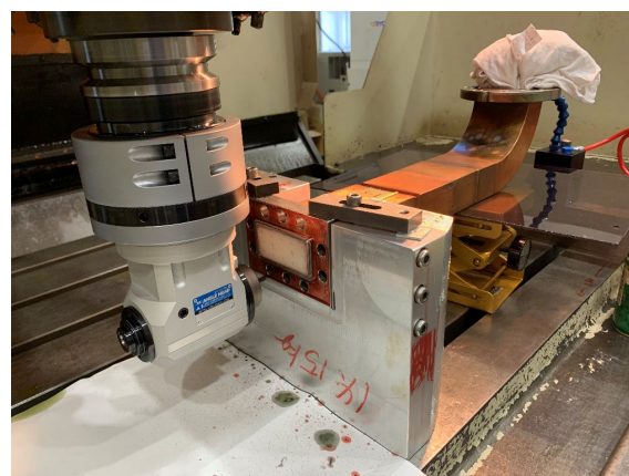
図 6 導波管フランジの加工中の様子
