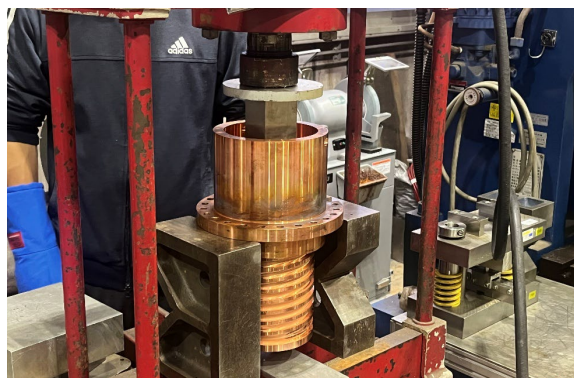
図 4 油圧プレスによる取外し
