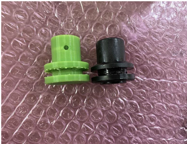
図2 試作したピストン(左)と元のピストン(右)
