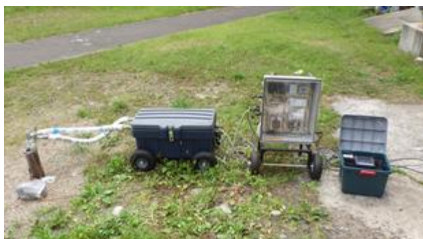
図 3 製作した TRT 装置 (1 号機)
