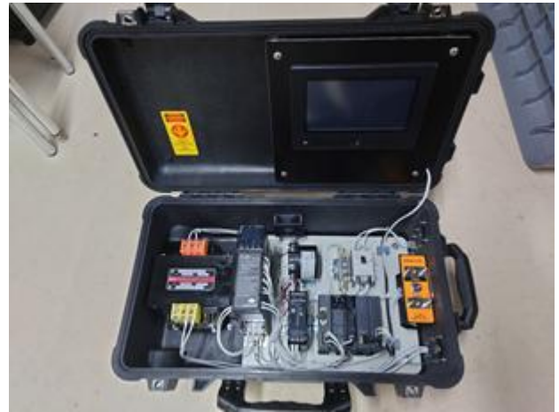
図8 TRT 装置4号機（ケーブルヒーター方式）
