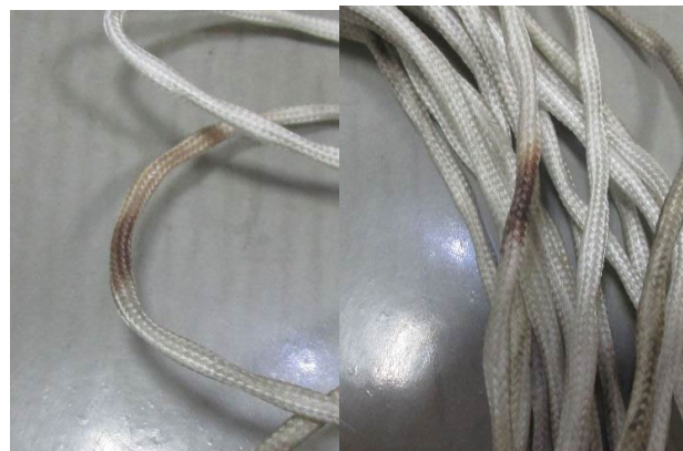
図 4 漏水センサ放電痕
