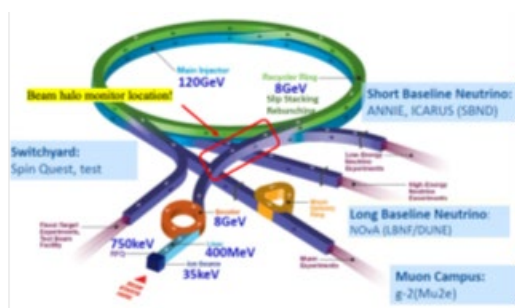
図1 FNALの加速器群とビームハローモニターの設置場所
