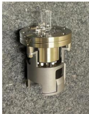
図 1 エクストラクタ真空計
