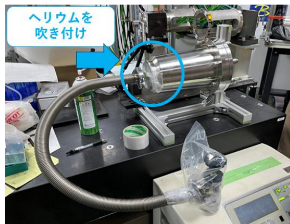
図 6 ヘリウムリーク試験の様子
