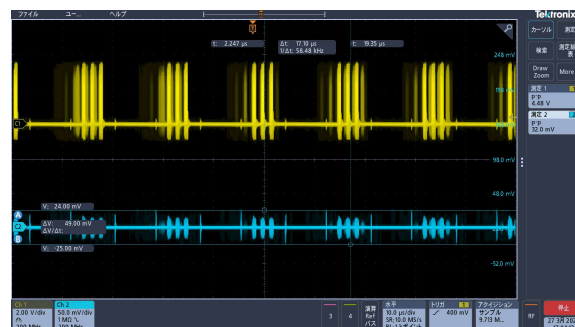
図7 SPI 通信のクロック波形(黄色)と出力に重畳する Voltage fluctuation (青色)
