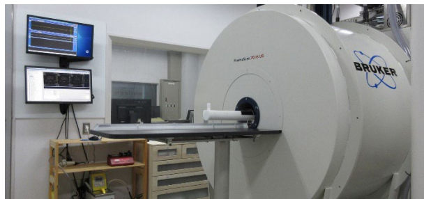
図 1 小動物用 MRI (年間 LHe 補充量約 400 L)
