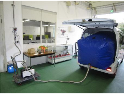
図 4 ②軽ワゴン車で輸送して 真空ポンプで回収
