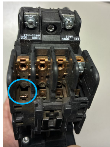
図1 R相の接点が消失したサーマルリレー
