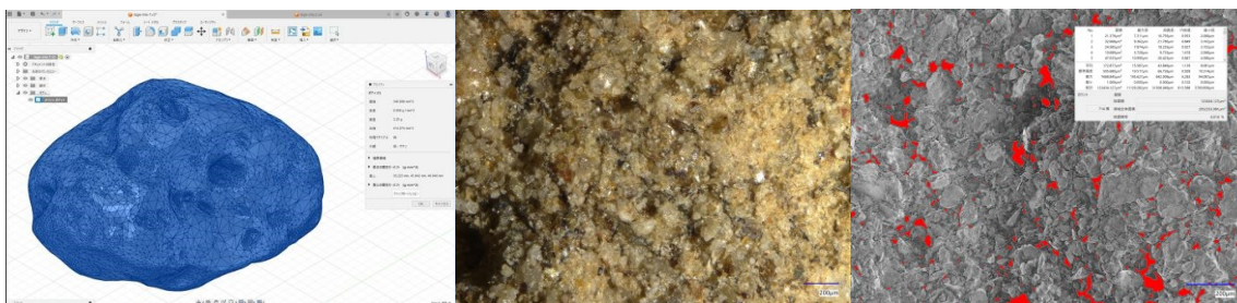
図 1. ソリッドモデル化による粒子表面 (3DCAD ソフトにて解析)
